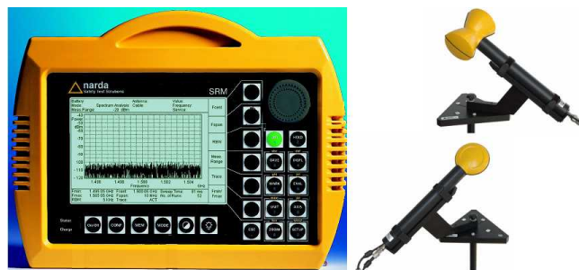
Figura 3. Analizzatore Narda SRM-3000 e sonde unidirezionali di campo elettrico 3531/02 (sopra) e di campo magnetico 3551/01 (sotto).
