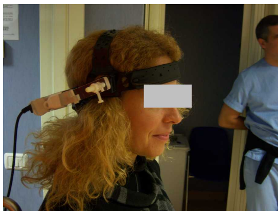
Figura 6. Dettaglio di una possibile modalità di posizionamento della sonda per la rilevazione del campo magnetico percepito (pMFD).
