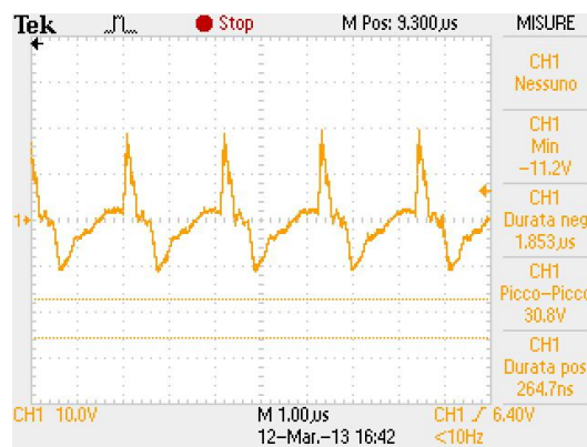
Figura 6. Elettrobisturi Alsa Excell MCDS, modalità taglio, forma d'onda della tensione su una resistenza di carico di 500 \Omega di uso comune.
