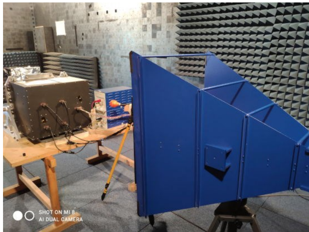
Tipica configurazione per verifiche di emissione o suscettività radiata con antenna a doppio corno, nella banda 200 MHz - 2 GHz (a sinistra) e di emissione condotta sulle linee di alimentazione con LISN, nella banda 150 kHz - 10 MHz (a destra).
