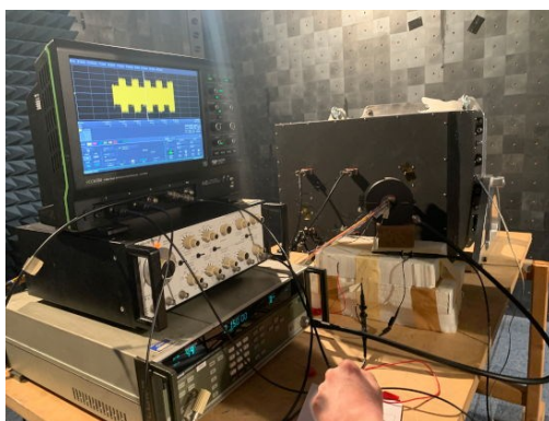
Figura 6 - Tipica configurazione per verifiche di suscettività condotta con sonda di iniezione di corrente, nella banda 10 kHz - 200 MHz.
