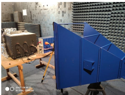
Figura 4 - Tipica configurazione per verifiche di suscettività radiata con antenna biconica, nella banda 30 MHz - 200 MHz.
